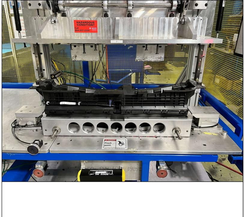
VANE BODY LOCATED IN POSITION ON TOP OF FRONT FRAME READY FOR ASSEMBLY
